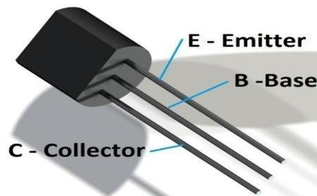
**Fig: 2.8.1. transistor**
