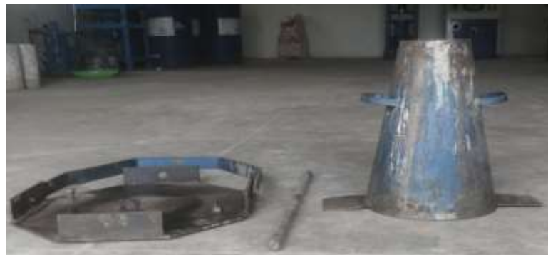
Fig. 5.2: Slump cone apparatus
