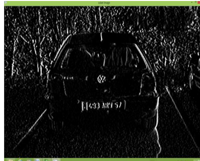
Fig.3. Sobel Vertical edge detection
